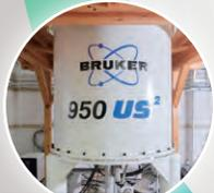
超高磁場NMR(溶液・固体)
